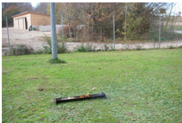
Abb. 10: 3 bis 5 sec; das Pulver ist verbrannt, nur noch Papier, Holz und Kunststoff brennen
