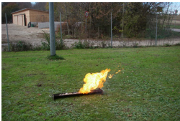
Abb. 9: 2 bis 3 sec; starker Abbrand, vereinzelt Funkenflug
